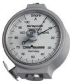
*Illustration 49: Duromètre portable Shore A*
