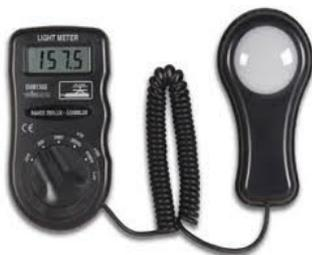
Le lux est une unité de mesure de l'éclairage lumineux (symbole : lx). Il caractérise le flux lumineux reçu par unité de surface. Un lux est l'éclairage d'une surface qui reçoit, d'une manière uniformément répartie, un flux lumineux d'un lumen<sup>70</sup> par mètre carré.
